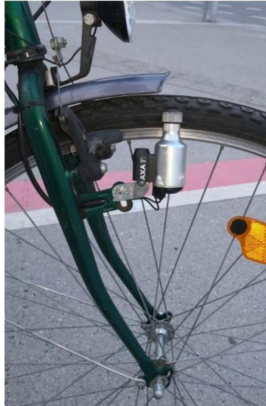
Abbildung 3 - Seitenläuferdynamo (eigene Darstellung)
