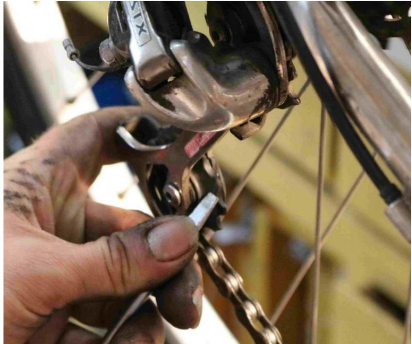
Bei hartnäckigen Schmiermittlrückständen können spezifische Fahrradprodukte oder andere fettlösende Mittel (z.B. WD40-Spray) verwendet werden.
