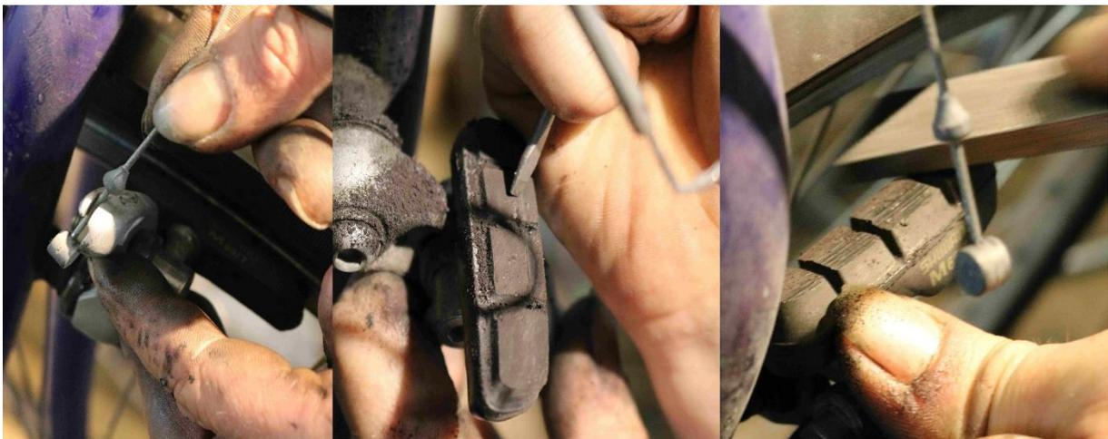
Ein Wechsel ist nötig, wenn am Bremsbelag keine Querrillen mehr vorhanden sind. Der Wechsel ist relativ einfach, es müssen jedoch zuvor neue Bremschuhe (Bremsbelag und Träger bilden eine Einheit) gekauft werden. Cantilever-Bremsen und V-Brakes erfordern unterschiedliche Bremschuhe.
