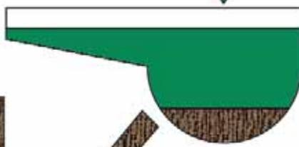
Das Wasser mit den Bakterien fließt weiter in das **Nachklärbecken**. Dort sinken die Bakterien zu Boden und an der Oberfläche wird vorsichtig das gereinigte Wasser aus dem Becken in einen Bach oder Fluss geleitet.
