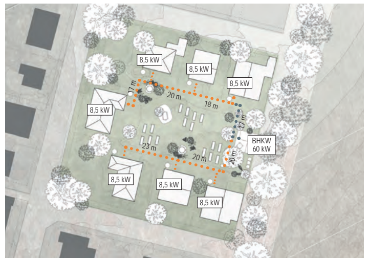
Gebäudeverband mit Mini-BHKW
